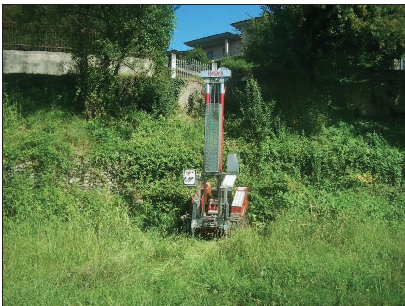
FIG. 17 Panoramica area in oggetto – Esecuzione SCPT 1
