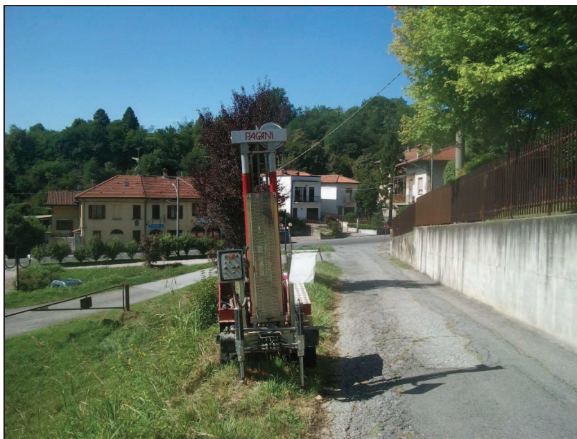
FIG. 26 Esecuzione prova penetrometrica dinamica SCPT 3
