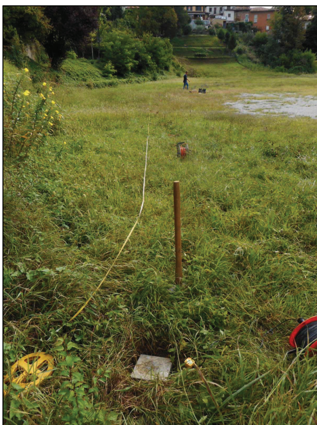
FIG. 13 Esecuzione stendimento sismico LS1
